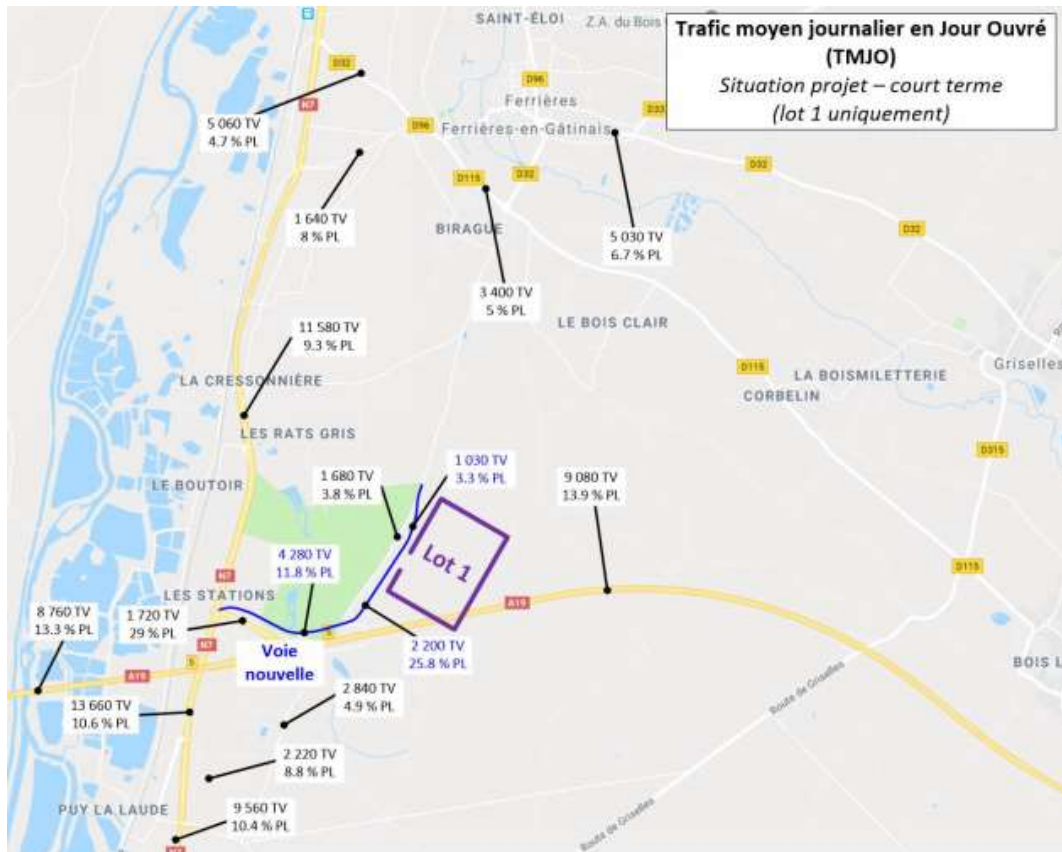
Estimation du trafic moyen jour ouvré en 2023 en présence de la voie nouvelle et après mise en service du site VAILOG (scénario projet court terme)
